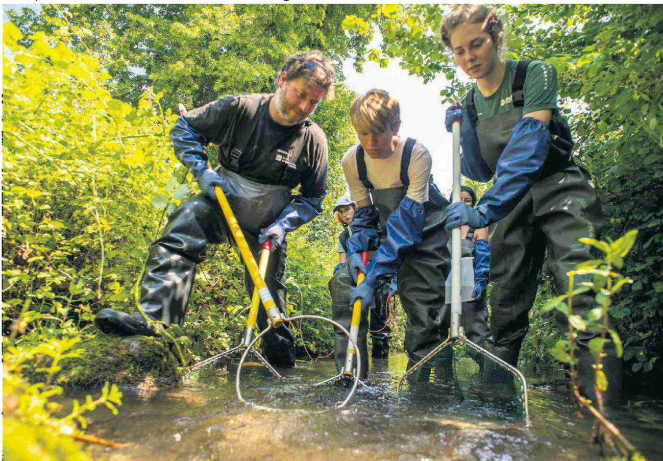
Les scientifiques capturent les poissons en induisant un courant électrique dans l'eau. Photos: Patrick Marti
